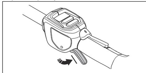
2. Pritisnite sprožilec plina in se prepričajte, da se ta po sprostitvi vrne v izhodišni položaj.
