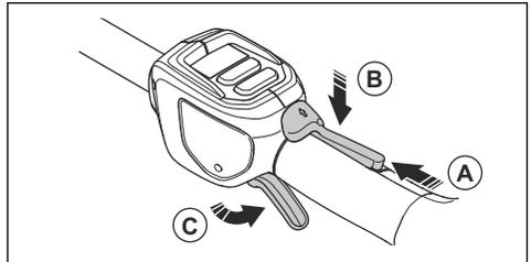
1. Stellen Sie sicher, dass der Gashebel gesperrt ist, wenn sich die Gashebelsperre in der Ausgangsstellung befindet.
