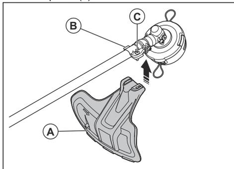
2. Ščitnik rezalnega priključka namestite na gred in ga pritrdite z vijakom (C).
