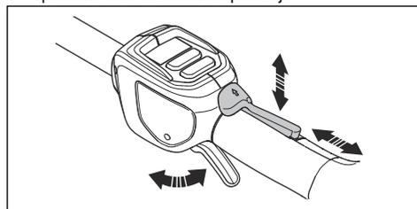
3. Sprožilnik plina in zaklep sprožilnika plina se morata prosto premikati in povratna vzmet mora delovati pravilno.
