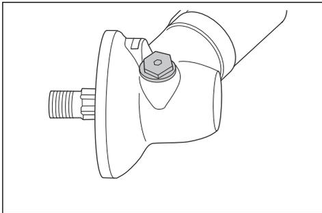
4. Sehen Sie in die Schmiernippel-offnung hinein, und drehen Sie die Antriebswelle. Der Schmierfettstand (A) muss sich auf Hohe der Zahnoberseite (B) befinden.
