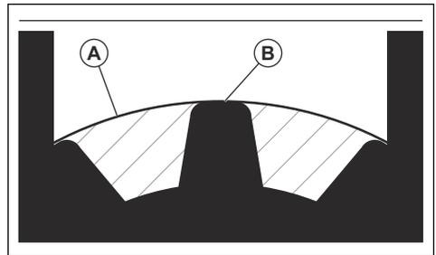
5. Wenn der Schmierfettstand zu niedrig ist, fullen Sie das Winkelgetriebe mit Husqvarna Schmierfett fur Winkelgetriebe. Fullen Sie es langsam ein, und drehen Sie die Antriebswelle dabei. Stoppen Sie beim korrekten Fullstand (B).
